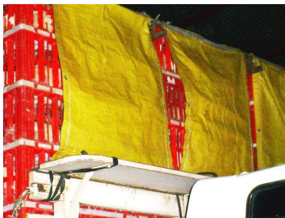
Figura 4: Caminhão de frangos de corte com detalhe para a lona de proteção nas caixas da frente (Fonte: NUPEA)
